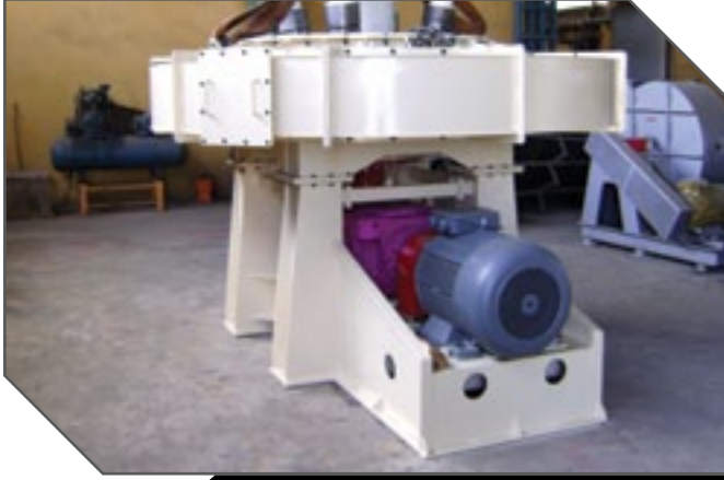
STD 1400 Sarkaç Toplu Değirmen STD 1400 Pendulum Roller Mill
