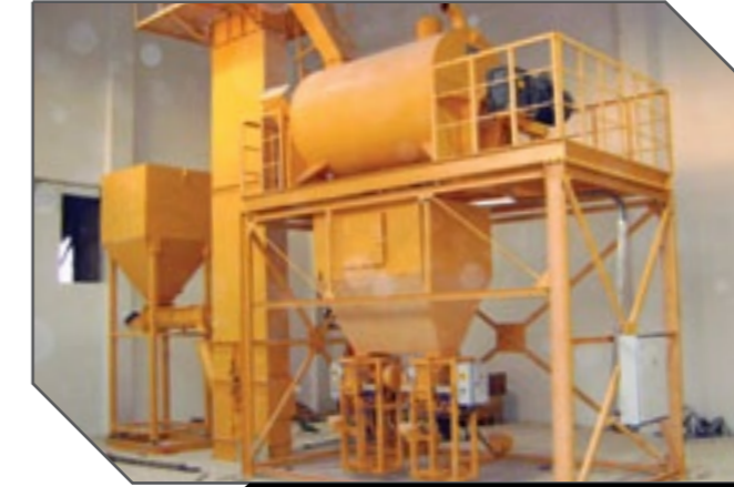
Yapı Kimyasalları Tesisi Dry Mix Mortar Plant
